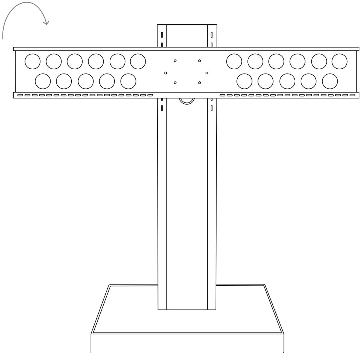
Hängen Sie die VESA-Aufnahme / VESA-Montageplatte in der gewünschten Höhe in die Raststufen der Säule ein.
