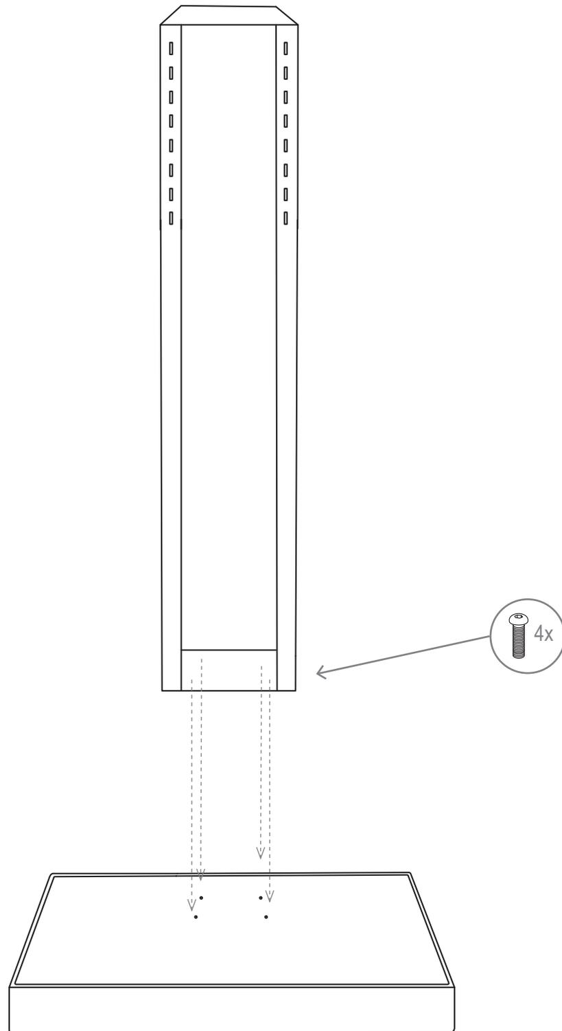
Legen Sie die Standsäule auf eine weiche Unterlage um Beschädigungen zu vermeiden. Verschrauben Sie die Bodenplatte mit der Standsäule, verwenden Sie hierfür die M8X45 Linsenkopfschrauben. Richten Sie die Säule anschließend vorsichtig auf.
