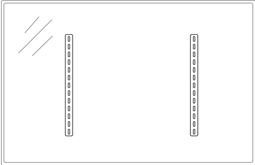
Montieren Sie die VESA-Arme rückseitig am Bildschirm. Schrauben bitte vorsichtig einschrauben und anziehen um Beschädigungen zu vermeiden. Verwenden Sie passende Schrauben aus dem mitgelieferten TV-Schrauben-Beutel.
